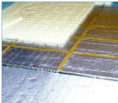
*Vakuum-Wärmedämmung mit minimaler Aufbauhöhe (Quelle: Variotec)*
